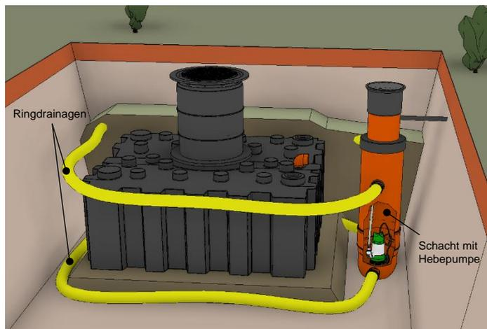
Abbildung 1: Baugrubendrainage
