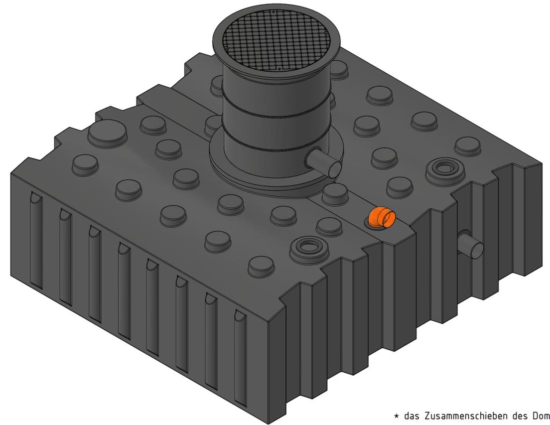
\* das Zusammenschieben des Doms auf Minimalhöhe erfordert das Ausschneiden des unteren Domsegments im Bereich der Rohre
