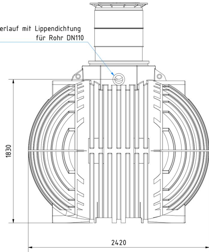
Leerrohranschluss mit Lippendichtung für Rohr DN110
