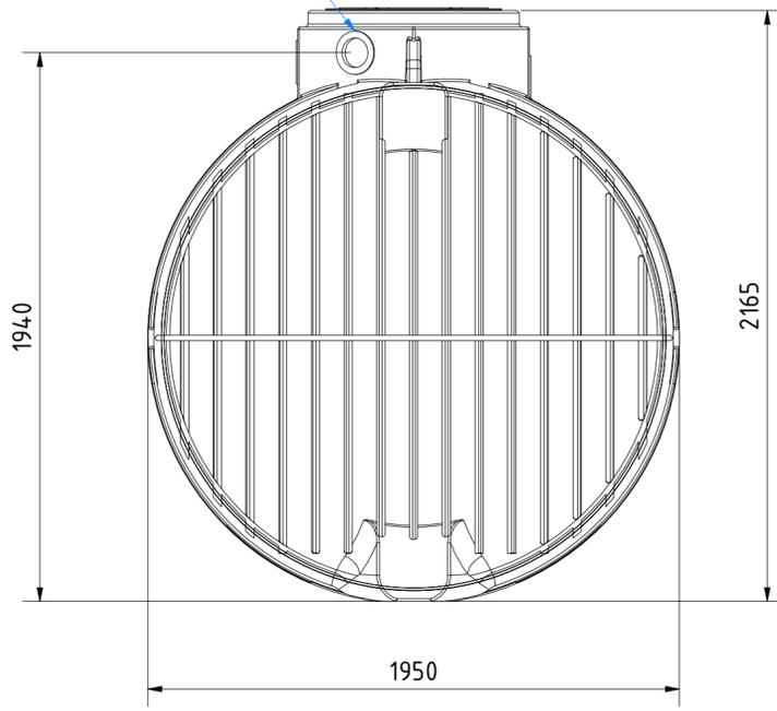
Zulauf mit Lippendichtung für Rohr DN110
