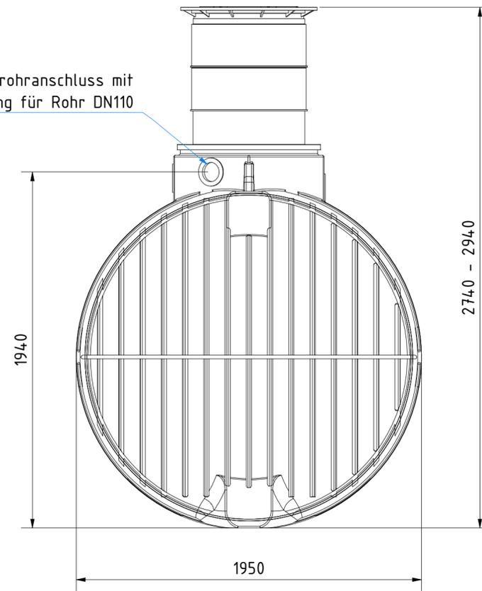
Zulauf mit Lippendichtung für Rohr DN110
