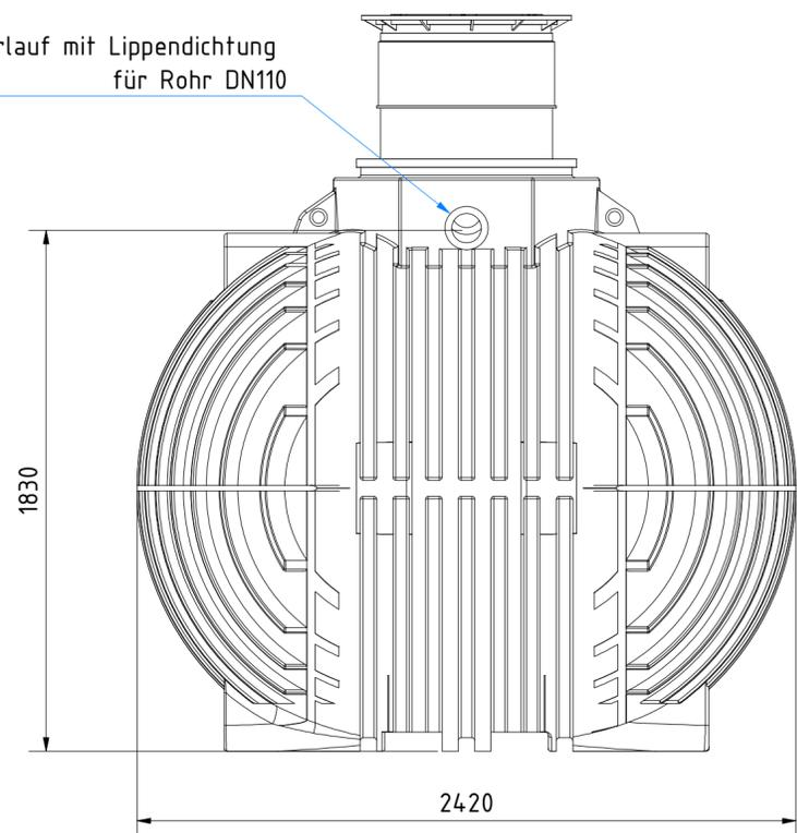
Leerrohranschluss mit Lippendichtung für Rohr DN110
