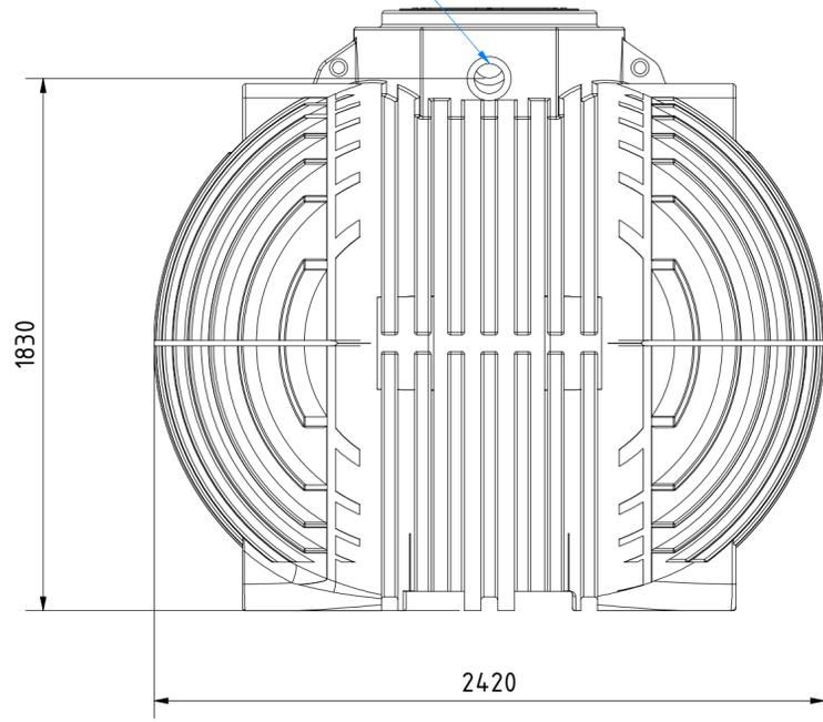
Leerrohranschluss mit Lippendichtung für Rohr DN110
