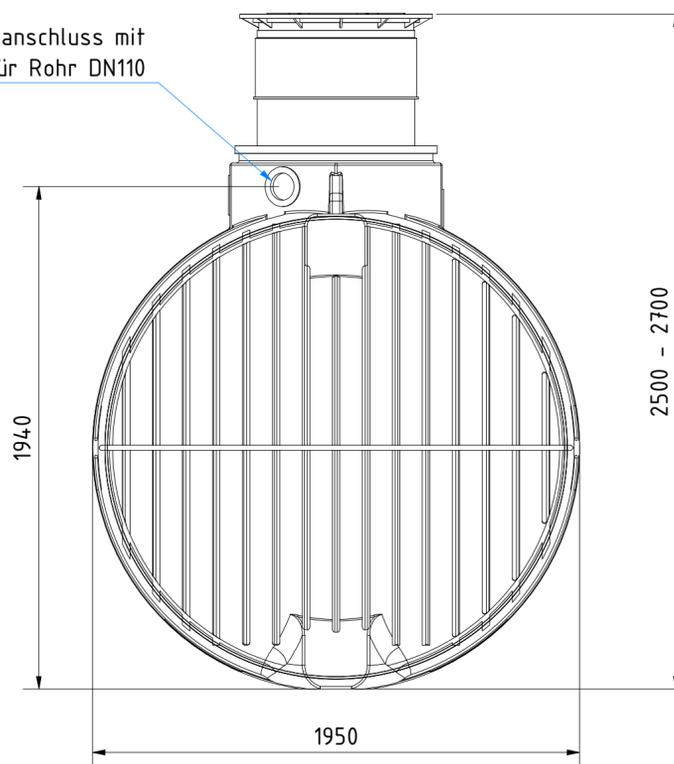
Zulauf mit Lippendichtung für Rohr DN110
