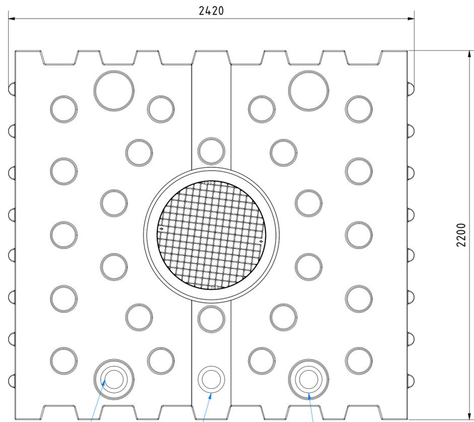
Freier Anschluss mit Lippendichtung für Rohr DN110
