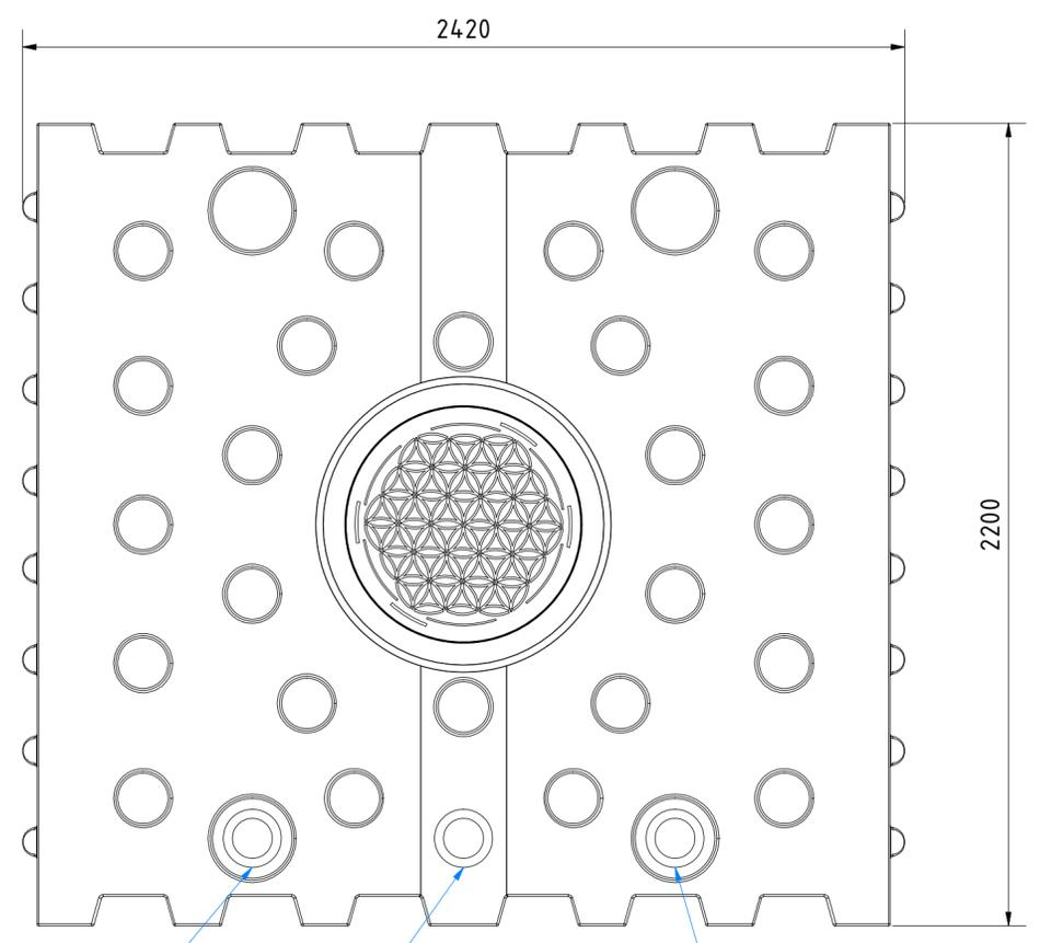
Freier Anschluss mit Lippendichtung für Rohr DN110
