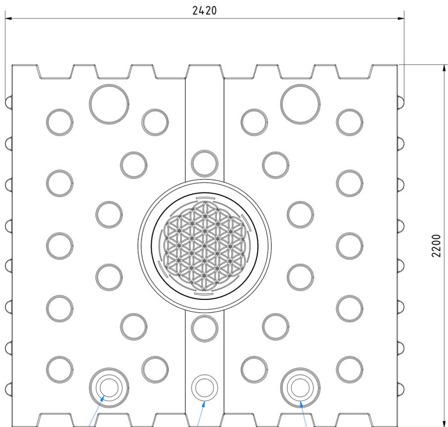
Freier Anschluss mit Lippdichtung für Rohr DN110
