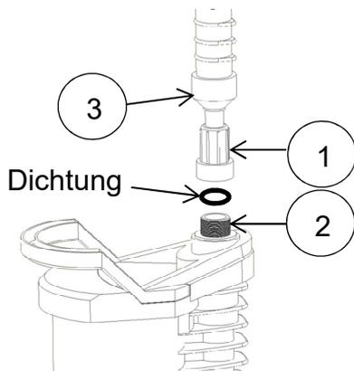
Schrauben sie das Teleskoprohr (1)
