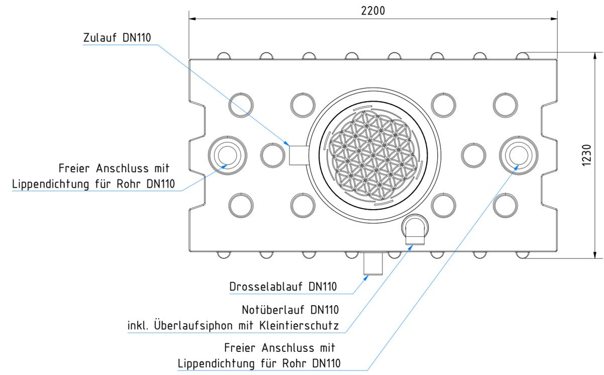
\* das Zusammenschieben des Doms auf Minimalhöhe erfordert das Ausschneiden des unteren Domsegments im Bereich der Rohre
